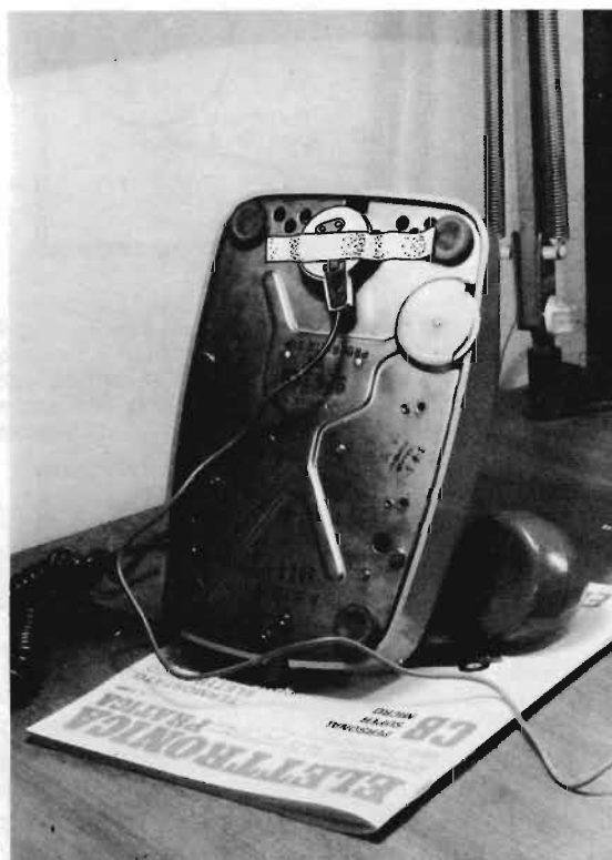
Fig. 5 - Con questa foto interpretiamo il sistema più idoneo per applicare la capsula microfonica nella parte inferiore dell'apparecchio telefonico, in prossimità dei fori dai quali fuoriescono gli squilli del campanello. Una porzione di nastro adesivo è sufficiente per fissaggio stabile del componente. Il collegamento deve essere effettuato tramite cavetto schermato.
